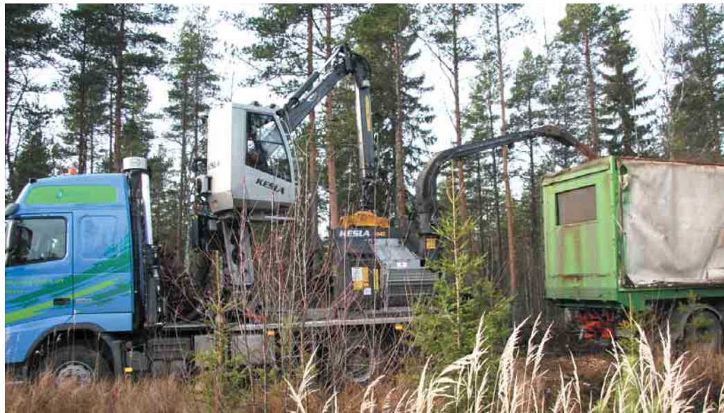
Viime kesänä hankittu Keslan hakkuri C645 on tehokas peli. Sillä tekee haketta 40 – 100 mottia tunnissa, tavarasta riippuen. Haketta tehdään 70.000 kuutiota vuodessa ja määrä on kasvussa.
