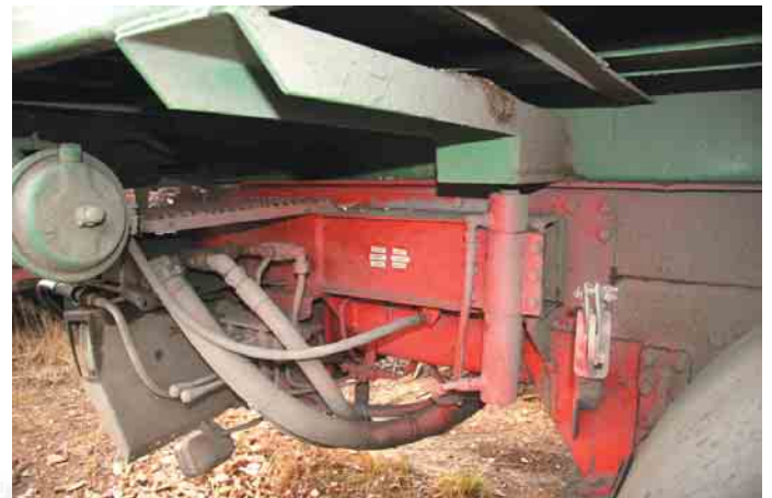
Puutavara-autosta on tehty monitoimimäntä. Hakekontti voidaan tarvittaessa nostaa sylintereillä pois ja laittaa jalkalavalla olevat puutavarapankot tilalle.
