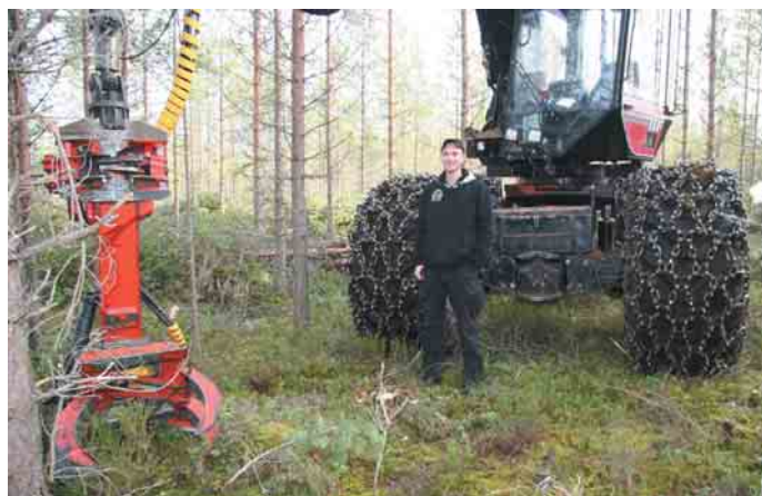
Energiapalvelu Ohrankämmenelle on Jarmo Mustalammin JP Forest Oy tärkeä yhteistyökumppani. Yksi moto on lähes jatkuvasti hakkaamassa energiapuuta. Sama yritys kuljettaa myös puut pois metsästä. Hakkuupäänä on Naarvan järein keräävä energiapuukoura. Konetta käskää Jami Salmela.
