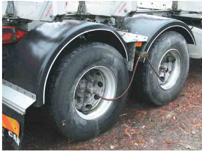
Paineensäätöjärjestelmän vaurioalttiilta näyttävä letkutus veto- pyörillä on osoittautunut lujaksi.
