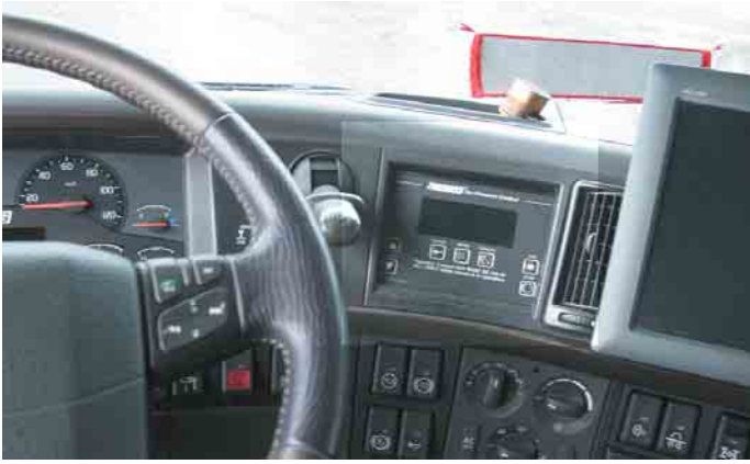
Väärälän Volvon CTI-järjestelmän asennukset tehtiin Oulun Wette-rillä. Ohjausyksikkö on upotettu "tehdasmaisesti" kojelautaan.
